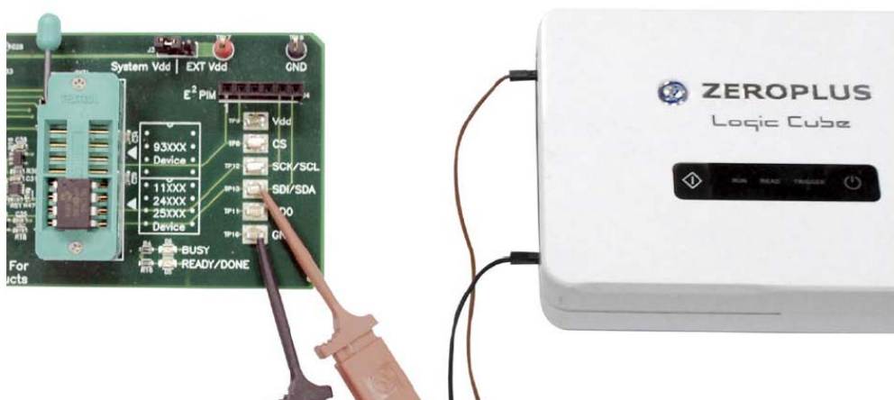
圖三：測量環境連接完成
