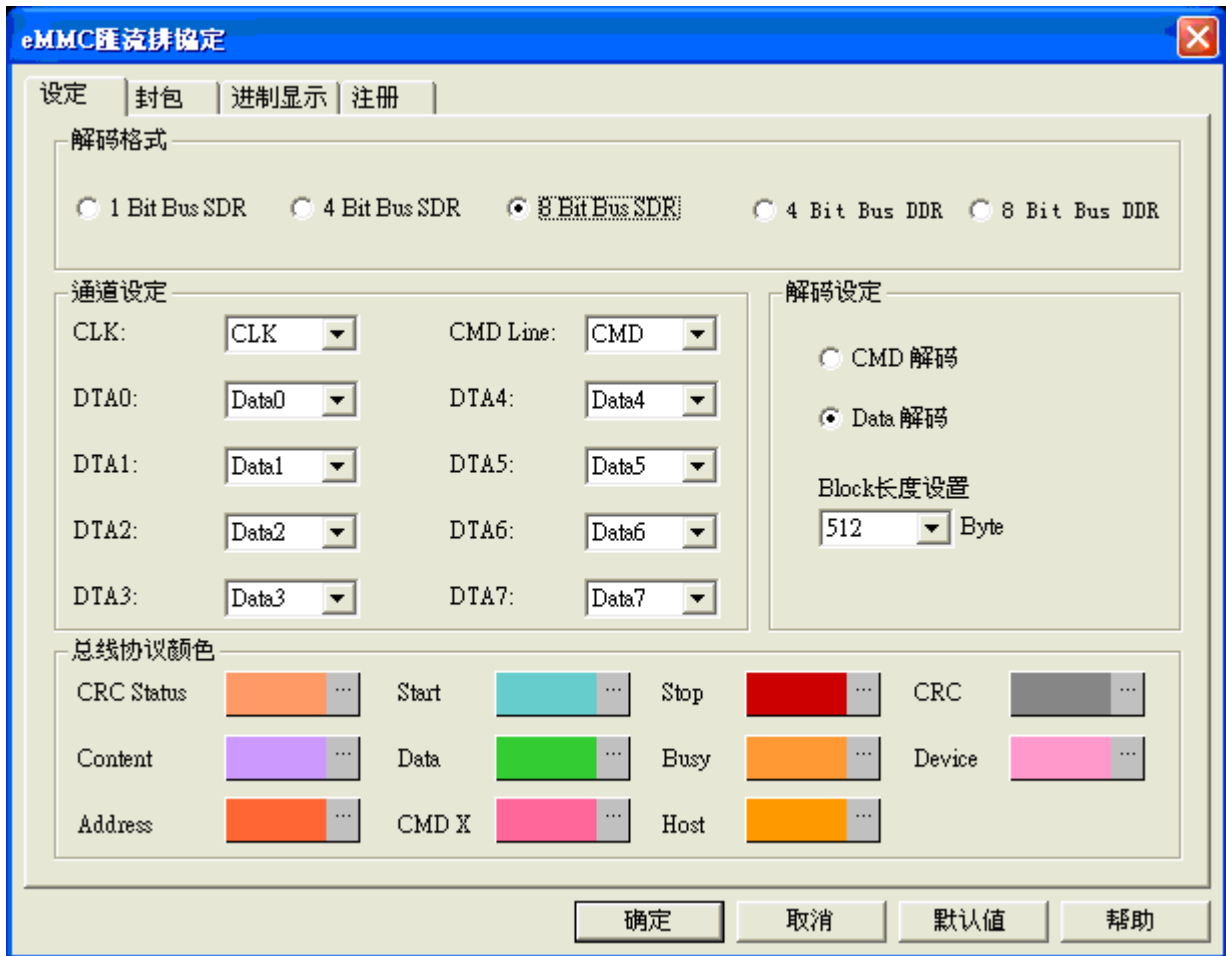
▲ 图九:孕龙科技逻辑分析仪 eMMC 总线分析模组设定视窗
