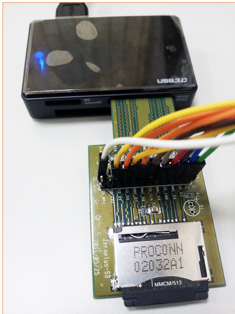
▲ 圖五：讀卡機與eMMC轉板並接上測試線，透過邏輯分析儀進行量測。
