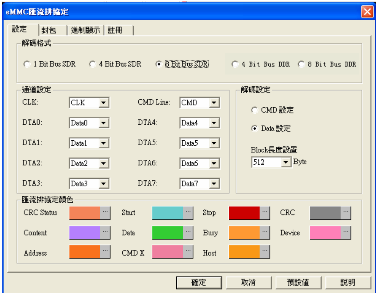
▲ 圖九：孕龍科技邏輯分析儀 eMMC 匯流排分析模組設定視窗
