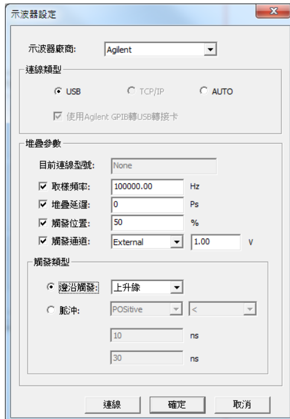
圖四：Agilent示波器進行堆疊設定
