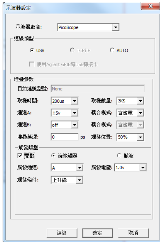
圖二：Picoscope示波器進行堆疊設定
