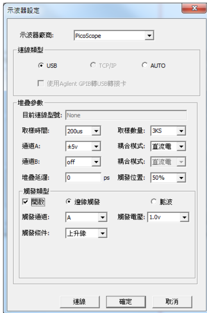
圖二：PicoScope示波器進行堆疊設定
