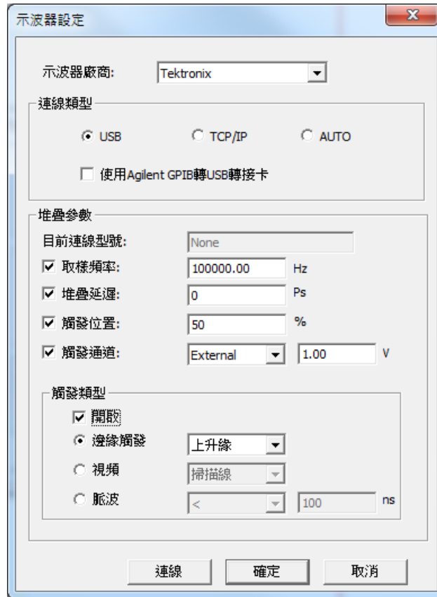
圖五：Tektronix示波器進行堆疊設定
