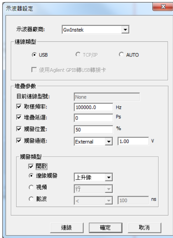
圖三：GwInstek示波器進行堆疊設定
