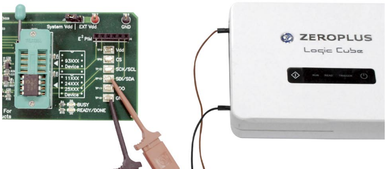
► 圖三：測量環境連接完成
