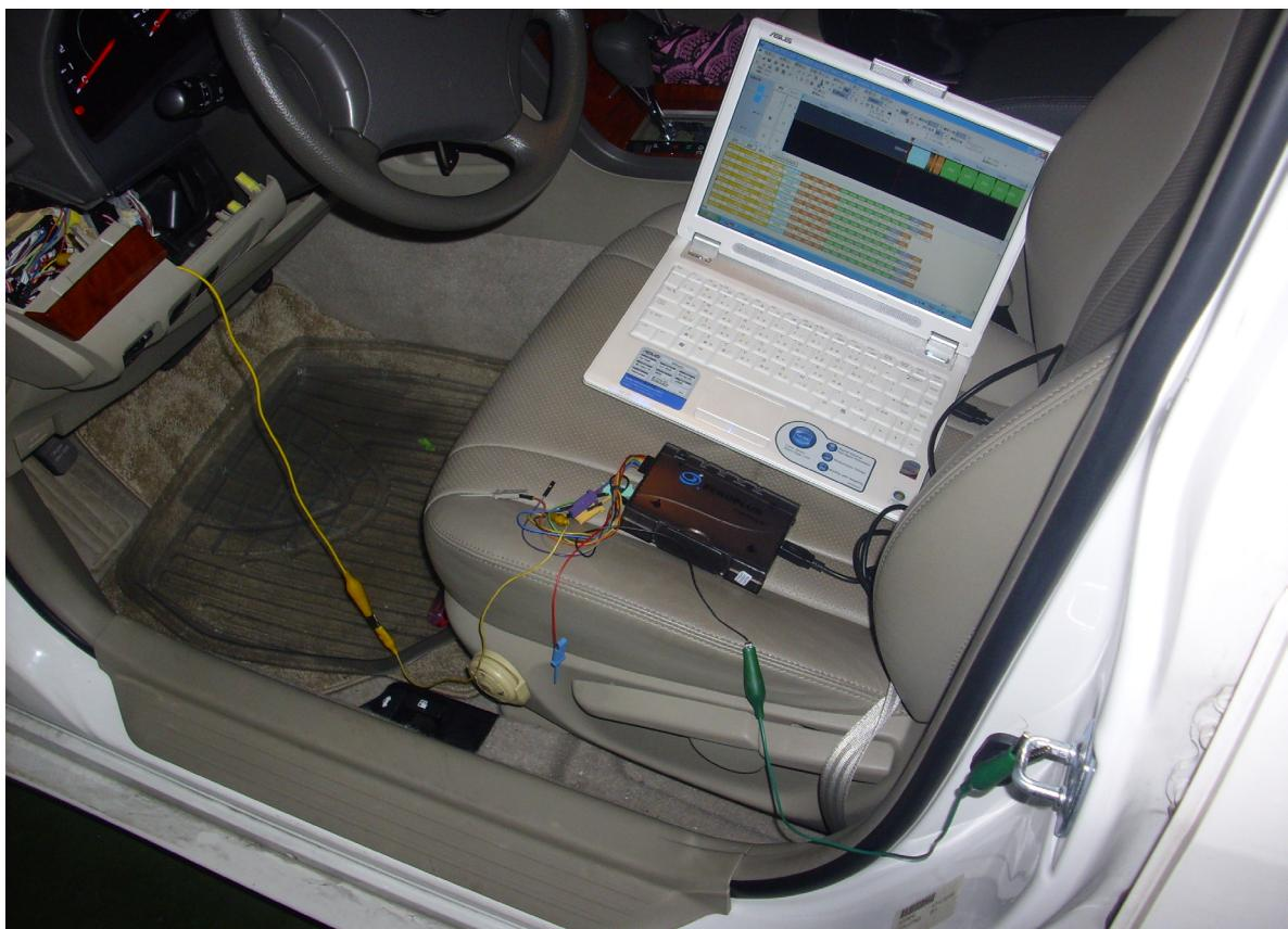
► 圖八 在汽車上實際測量CAN BUS訊號
